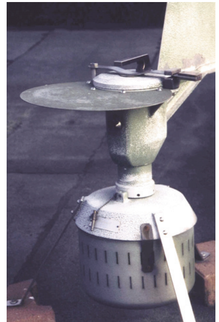
Ob in Frankreich, Italien oder Israel – die Burkard Pollenfalle dient zur Messung der Pollenkonzentration.
